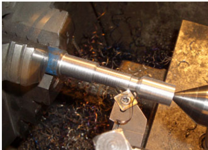
Cilindrando la herramienta
